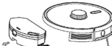
Modello VR3120 - Contenitore per l'acqua controllato elettricamente
