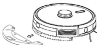
Modèle VR3100, VR3110 - Réservoir d'eau suspendu
